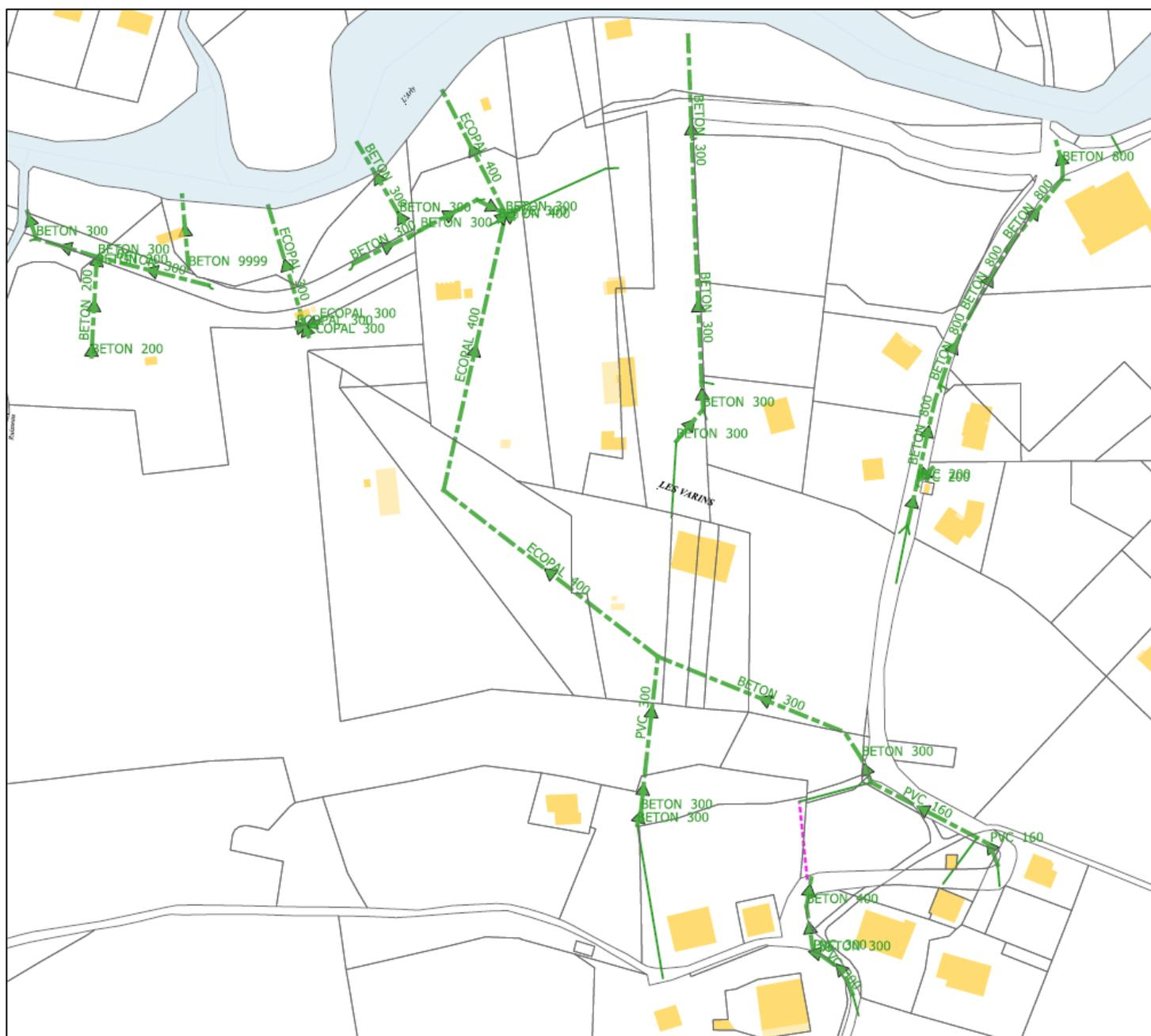
Extrait du plan du réseau d'eaux pluviales dans le secteur des Varins
